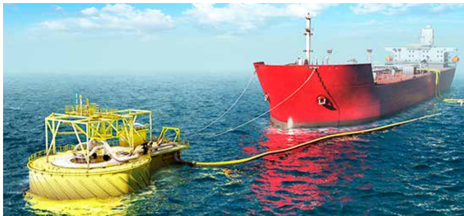
Løsningen skal overvåke forankringslinjene til Jubilee Buoy Turret Loading (BTL) bøyen i Vest-Afrika. (Image courtesy of APL Norway AS).
