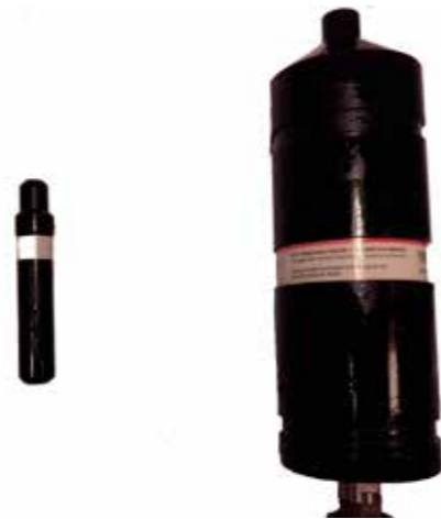
Figur 1 Den 10 cm lange sensor-enheten vises til venstre, den 23 cm mm lange mottakeren til høyre. Mottakeren kan motta data fra mer enn 50 sensor-enheter samtidig.
