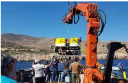
MV PHILIA sjøsetter sin ROV med kran.
