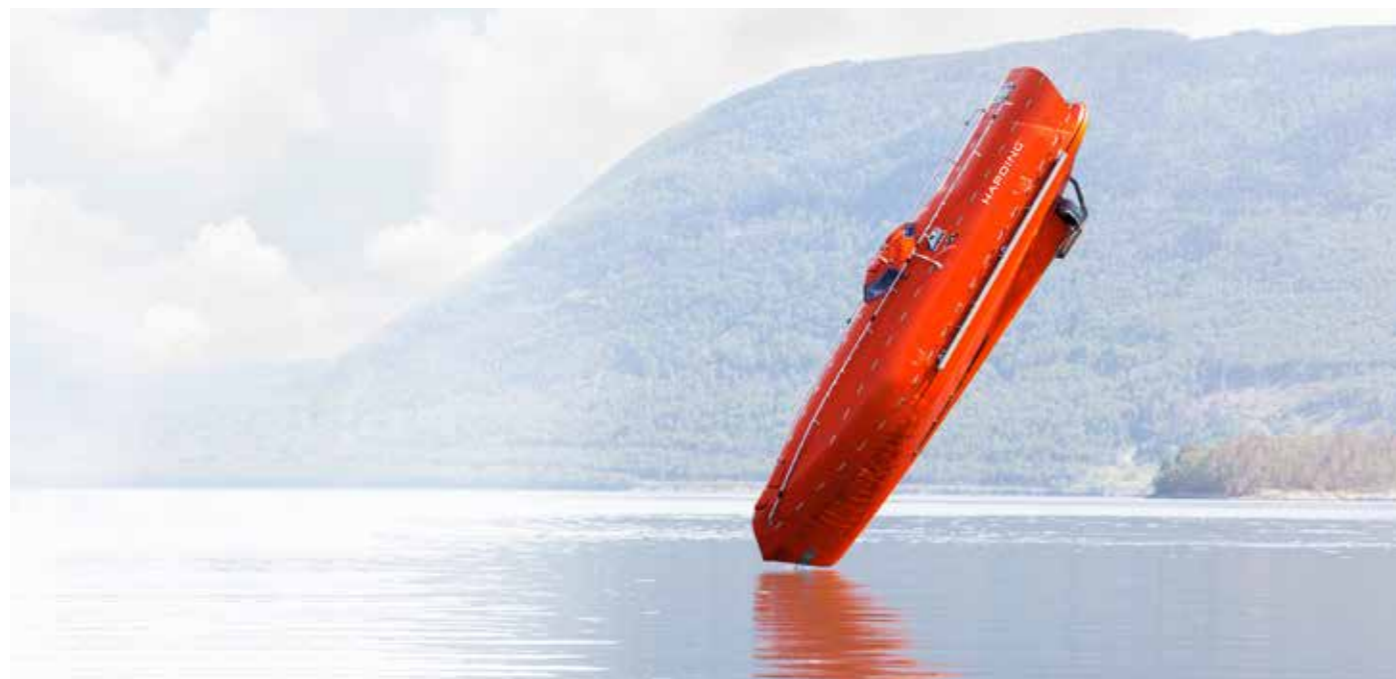
Figur 1 Hardings FF1200 livbåt under dropp tester. Bilde: Harding
